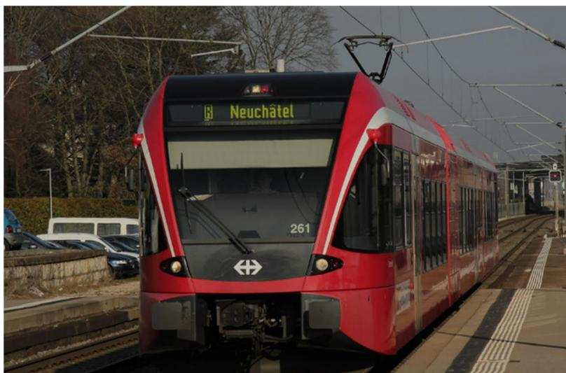
Abbildung 2: RABe 526 Gelenktriebwagen (für die Berechnung der Emissionen wurde dieser Zugtyp eingesetzt)
